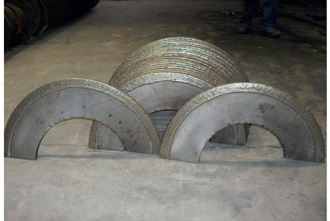
Recargues duros en zona de avance para conseguir una mayor durabilidad y una mayor resistencia al desgaste, a choques y a temperaturas.
